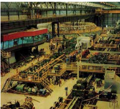
Laminador continuo de Siderca para tubos, 1988. Fuente: Boletín Techint N° 254 (septiembre-octubre 1988)
