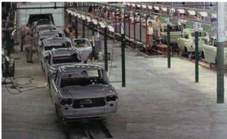
Planta de Fiat en Caseros, línea de salida del horno de pintura, 1963.
